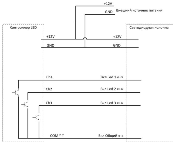
**6. Подключение светодиодной колонны без встроенного блока питания. Контроллер питается от RS232 (5 ... 12В). Светодиодная колонна питается от внешнего блока питания (5 ... 24В)**
