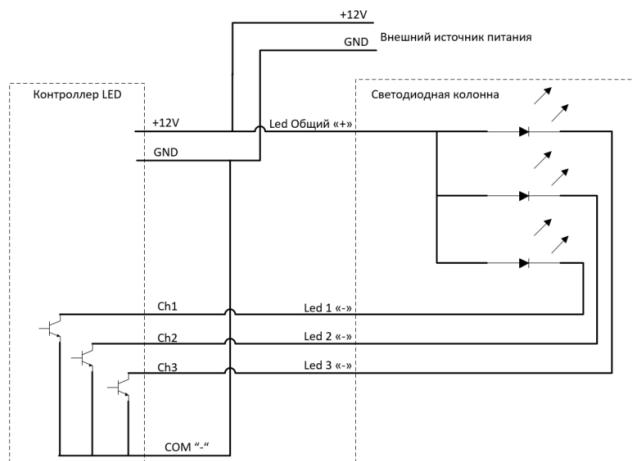
**5. Подключение светодиодной колонны со встроенным блоком питания к контроллеру к внешнему блоку питания (5 ... 12В)**
