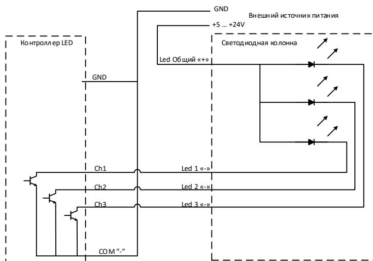
**7. Подключение светодиодной колонны без встроенного блока питания. Контроллер питается от внешнего блока питания (5 ... 12В). Светодиодная колонна питается от внешнего блока питания (5 ... 24В)**
